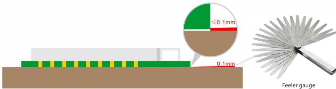
Module Bow and Twist:  $\le 0.1\text{mm}$
